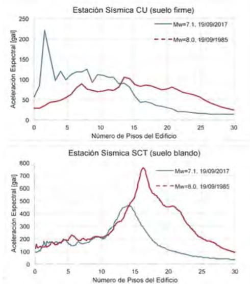
Aceleraciones experimentadas en las azoteas de edificios con diferentes alturas en los sitios CU (a, suelo firme) y SCT (b, suelo blando) para los sismos de 19 de septiembre de 1985 (rojo) y 2017 (azul). 1 gal = 1 cmls<sup>2</sup>. Las aceleraciones reportadas corresponden al promedio geométrico de ambas componentes horizontales del movimiento.
